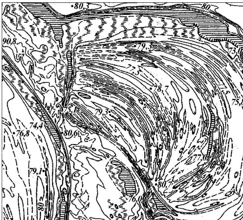
Рис. 19. Сегментная пойма - изображение на топографической карте (сечение горизонталей через 2,5 м)
